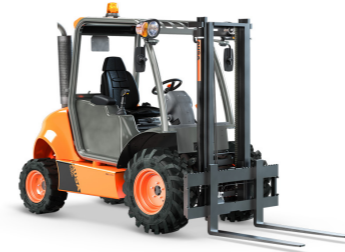
C150H x2/x4 1500KG 구동방식 4x2 / 4x4 COMPEN® 마력 24.8hp 차폭 1300MM 유압식변속기
