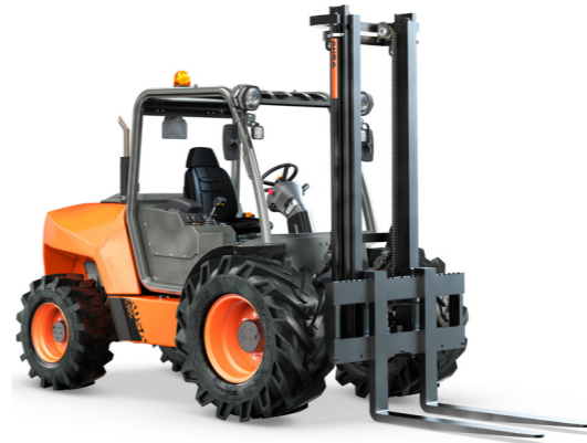
C351H 3500KG 구동방식 4x4 FULLGRIP® 마력 41.8hp 차폭 1780MM 유압식변속기
